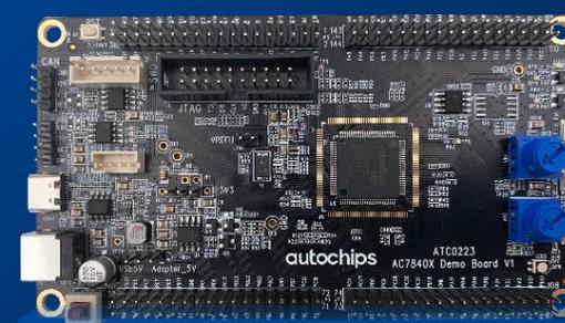
4路CAN，兼容CAN2.0B规范，支持CAN FD；4路UART，支持UART LIN复用；3路SPI、1路I2C、1路eIO，eIO可模拟多路SPI、UART、I2C、PWM等接口，最高支持128个GPIO。还配备了Type-c的UART打印接口、JTAG/SWD仿真口、2个电位器以及RGB LED等。
